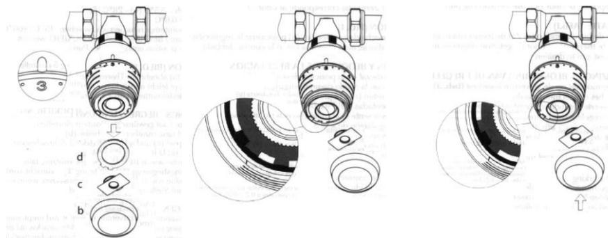
Рис 4.б,в,г Настройка термостатической головки.
